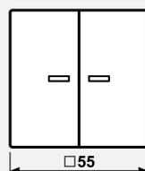
**IP** В соответствующих сериях с уплотнителем арт.: 551 WU и «рамкой IP 44» обеспечивается степень защиты IP 44.
